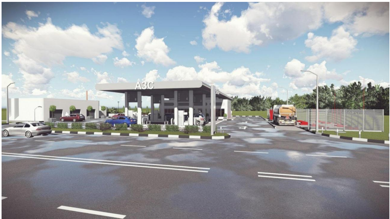
Подсветка островка и зоны въезда\выезда на АЗС Осветительные столбики высотой < 0.9м Рис. 7
