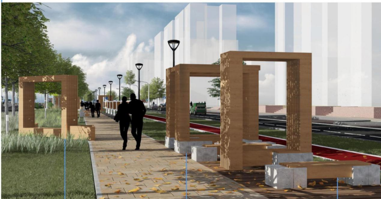
Деревянная пергола со скамьей на бетонном основании
